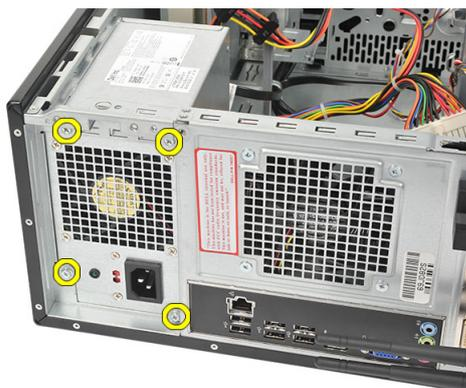
5. Presione el botón de liberación situado en la base del chasis del equipo y deslice la unidad de suministro de energía hacia la parte frontal del equipo.
