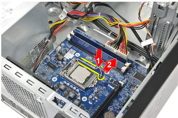
7. Levante la cubierta del procesador.
