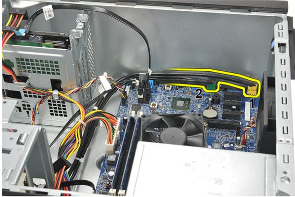
4. Desenrolle el cable de los sujetadores metálicos.
