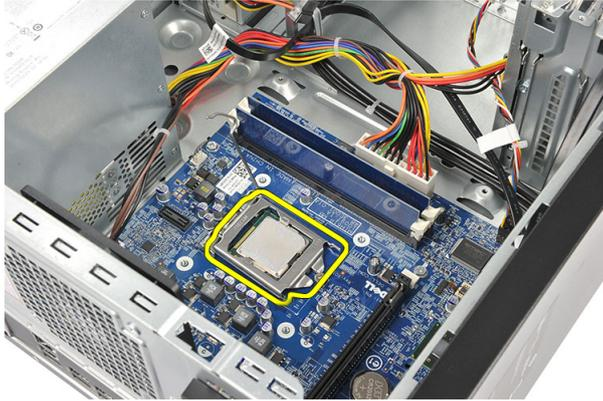
8. Levante el procesador, extráigalo del zócalo y guárdelo en un embalaje antiestático.
