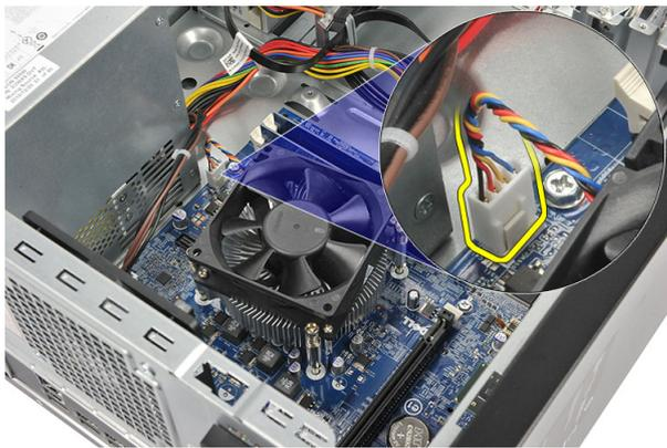
4. Afloje los tornillos cautivos que fijan el ensamblaje del ventilador y disipador de calor a la placa base.
